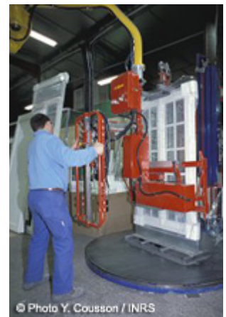
© Photo Y. Cousson / INRS Outil de préhension pneumatique permettant la manipulation de portes et de fenêtres
